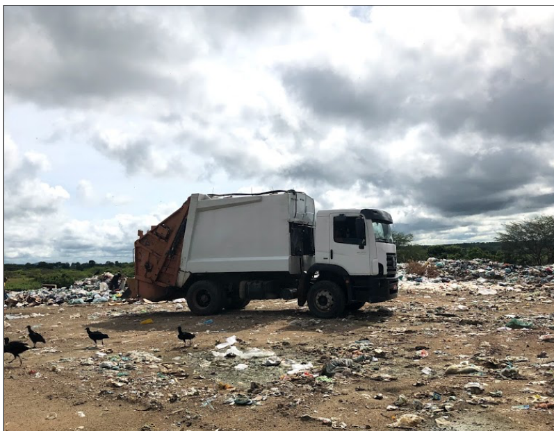
Figura 11 - Caminhão compactador (coleta de rejeitos)
