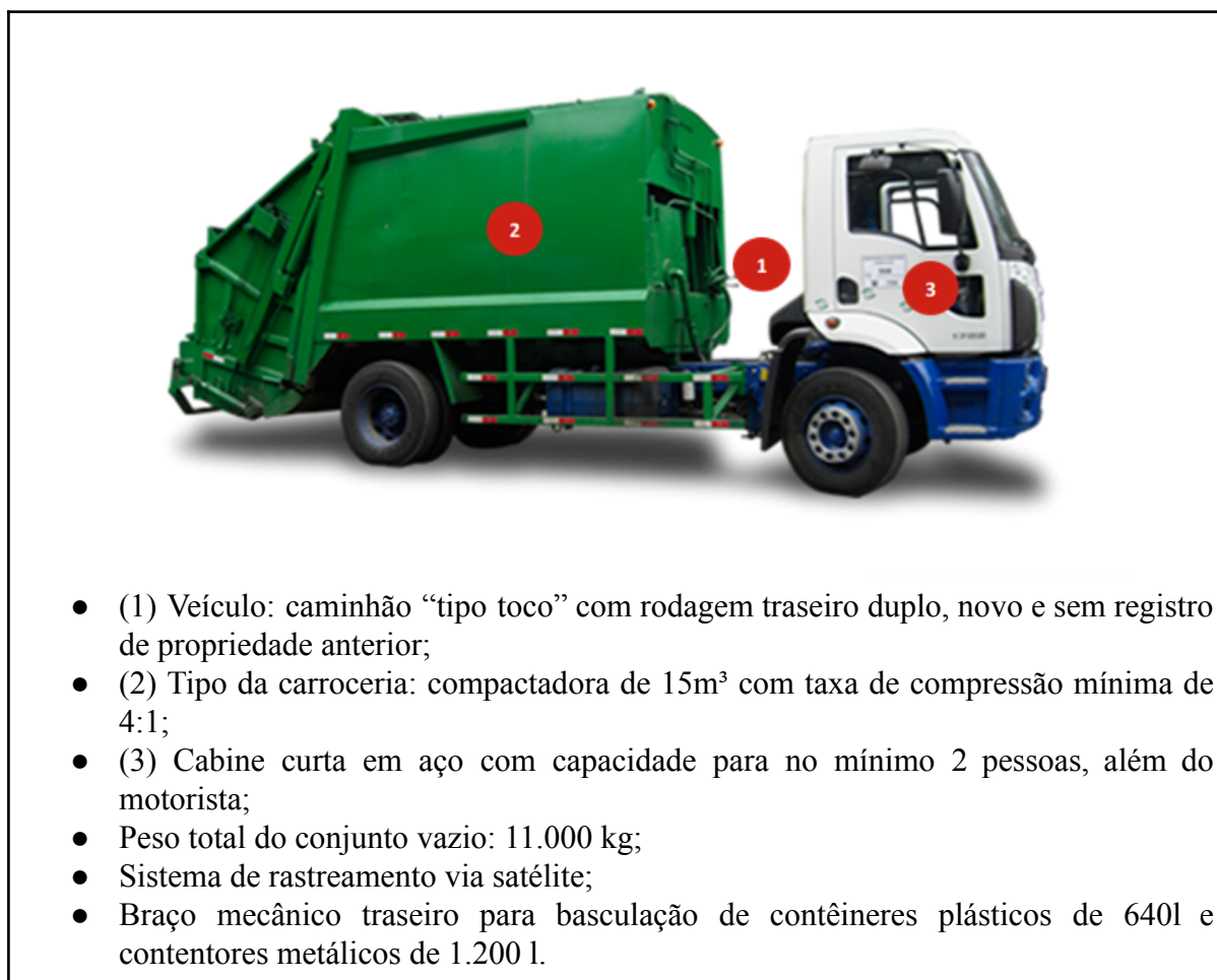
Figura 29 - Características básicas recomendadas do veículo para coleta de rejeitos (Canal Cinza)
